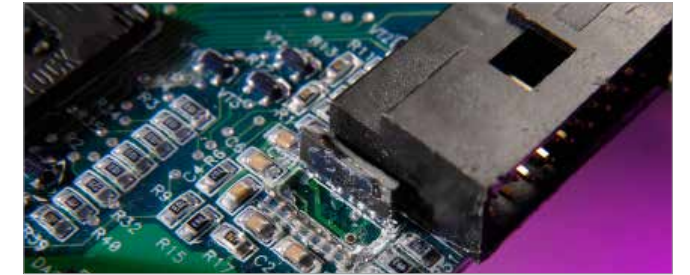
阴影区域的固化 - 1. Multi-Cure® 加热/湿气双重固化技术
